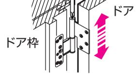
上下方向の調整後、枠側丁番(上)のキャップも調整して下さい。
