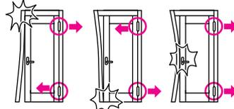
ドアが自動的に開閉してしまう時は、ドアが枠にあたらない範囲で以下の調整を行って下さい。
